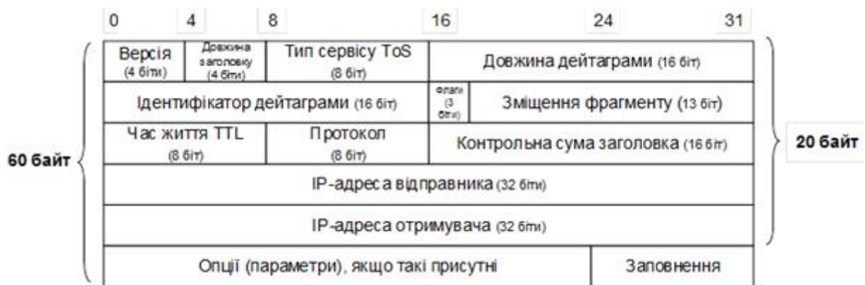
Рисунок 2.7 – Формат заголовку IP-дейтаграми
