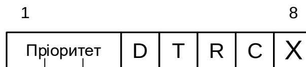
Рисунок 2.8 – Структура байту «Тип сервісу»
