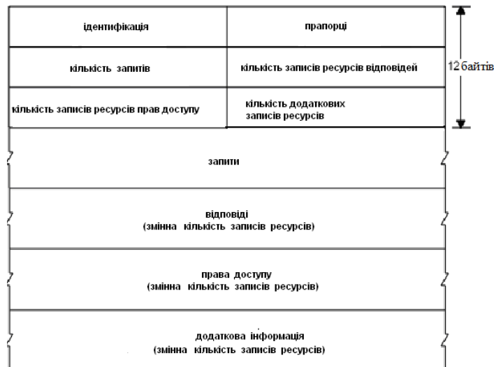
Рисунок 5.7 – Загальний формат DNS-запиту і DNS-відповіді
